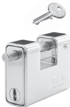
Lucchetto rettangolare BOXER con chiave estraibile solo a lucchetto chiuso, **CORAZZATO SU TUTTI I LATI**, per serranda. Corpo in zama contenuto in una corazza in acciaio carbonitrurato e cromato da mm 90. Funzionante con monocilindro a profilo europeo **F5** da mm 40 (30+10) camma sporgente art. 820930107 in dotazione. Stelo in acciaio INOX da Ø 12, zigrinatura per apertura. Bloccaggio stelo con sfera. **LUCE STELO mm 36X17,5**.
