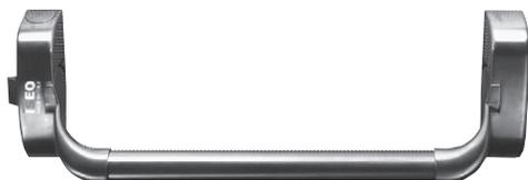
Maniglione antipanico "IDEA Base PVD - Inox" **MODULARE**, reversibile, finitura in PVD - INOX. Predisposto per chiusura laterale, duplice, triplice. **SCROCCO IN ACCIAIO CON AUTOBLOCCANTE**, idoneo per porte TAGLIAFUOCO. Incontri INOX 94100112. Due piastre di fissaggio in INOX 94100042. Predisposto per aggancio aste per alto/basso. Tappi per fori alto/basso. Spessore in nylon per comando esterno. Dima. Istruzioni di montaggio.
