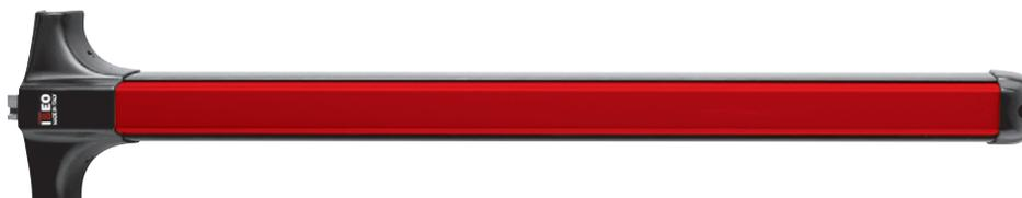
Maniglione antipanico **"Push Bar" MODULARE REVERSIBILE**, predisposto per aggancio aste. Scrocco in acciaio con autobloccante, idoneo per porte TAGLIAFUOCO. Tappi per fori alto/basso. Fermo a giorno. Incontri a corredo. Dima. Istruzioni di montaggio
