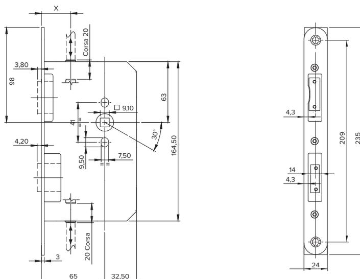
Controserratura antipanico per l'apertura/chiusura dell'anta secondaria di una porta tagliafuoco antipanico a 2 ante.
