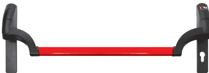
Barra di azionamento **Palmo** per porte TAGLIAFUOCO, PER ANTA PRINCIPALE E SECONDARIA, **REVERSIBILE**, abbinabile a serrature antipanico e contro serrature da infilare con quadro maniglia da 9 mm. Interasse mm 72, con rotazione quadro maniglia di **30°**. Dima. Istruzioni di montaggio. QUADRO MANIGLIA NON IN DOTAZIONE. Marcatura CE EN1125. Marcatura UKCA.
