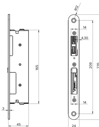
Controserratura Flush Bolt, con leva manuale, per l'apertura/chiusura dell'anta secondaria.
