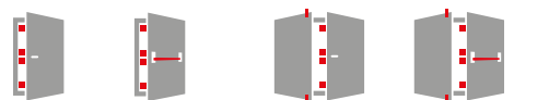
MULTIPUNTO MULTIPUNTO EXIT per dispositivo di emergenza o antipanico MULTIPUNTO + seconda anta semifissa con spagnoletta MULTIPUNTO EXIT per dispositivo di emergenza o antipanico + seconda anta semifissa con spagnoletta
