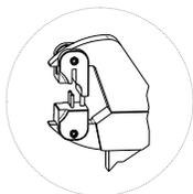
Pinza modificata per installazione e rimozione spine cilindro modulare LE60 1 0033094
