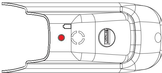
**Spia stato pile - Battery light - Indicateur de la batterie
